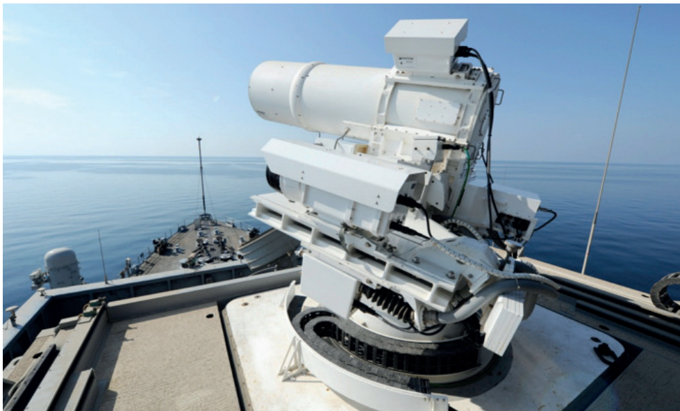
Figura N°10 –Sistema LaWS montado a bordo del USS Ponce. Extraída de: https://news.usni.org/2016/06/23/moran-directed-energy
