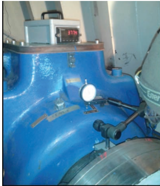
■ Microprocesador indicador de carga marca Omega y reloj comparador rango 0-10mm durante la medición de carga en el descanso intermedio de la línea de ejes.
