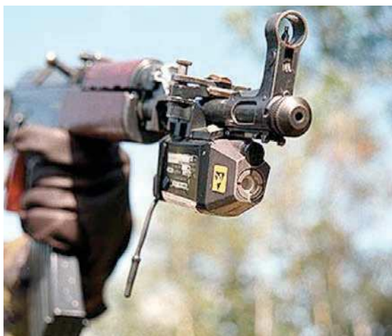
■ Figura 7. Sistema de transmisión para armas pequeñas ( Small Arms Transmitter ).
