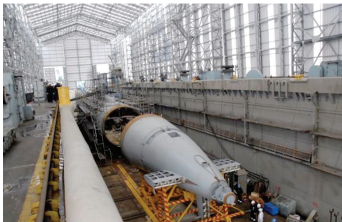
■ Submarino con su casco de presión cortado.
