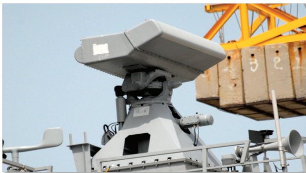
■ Radar MW08 a bordo de Meko 200.
