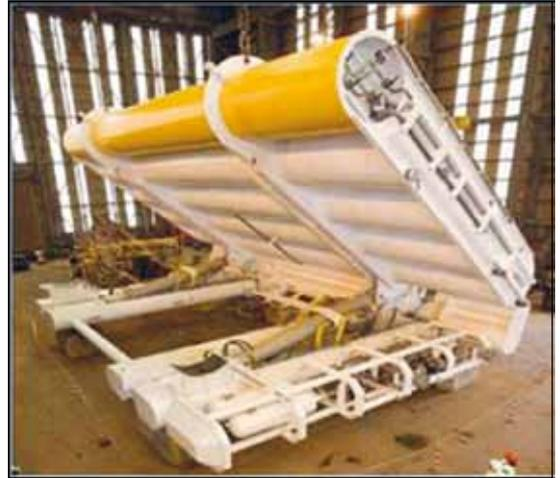
Figura 6. a) Dispositivo Waveroller [7]. b) Dispositivo Oyster [4].
