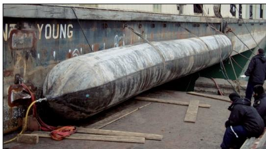
*Se instaló un roller bag por banda al costado del dique.*
