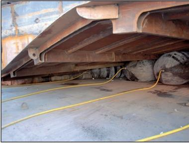
Se produce una deformación en la plataforma de giro.
