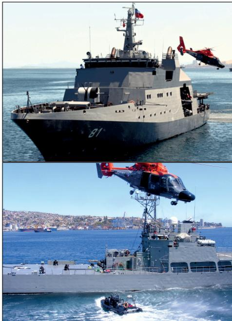
➤ El ARM PO-62 “*Baja California*”, PO-162 de la Armada de México. Está diseñado bajo el principio del trinomio Buque – Helicóptero – Embarcación Interceptora, el que lo dota de excelentes capacidades de maniobra para el desarrollo de las operaciones de vigilancia, búsqueda, rescate e intercepción. En la cubierta de vuelo cuenta con una rejilla de anclaje y un sistema que le permite al helicóptero rea-
