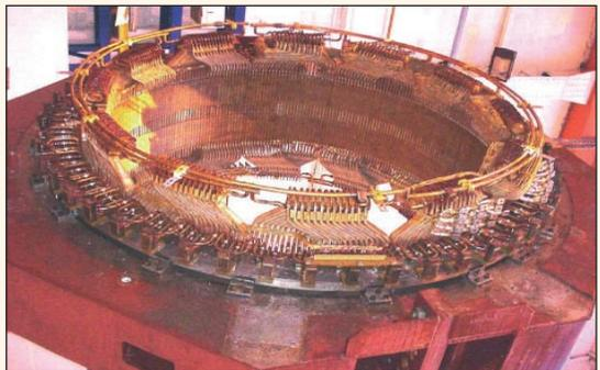
Estator del Motor del SS "Carrera".
