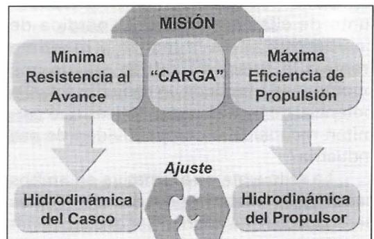
Figura 2. Factores de diseño de un buque.
