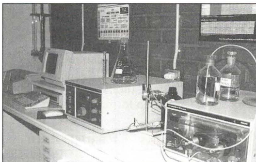
Equipo de cromatografía líquida para monitoreo de estabilidad vía estabilizantes.
