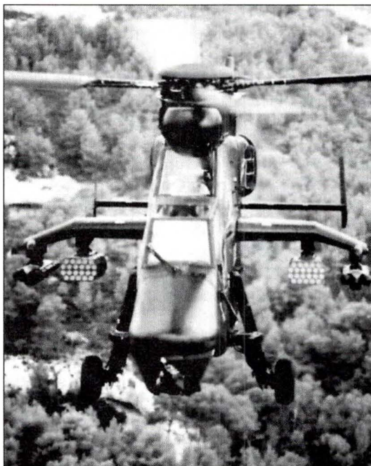
Sistema ATAM con misiles Mistral, montaje en helicópteros militares.
