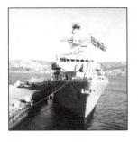
Otra de sus características relevantes es el sistema de propulsión mixto de turbinas a gas y diesel-eléctrico, que al operar en esta última modalidad le permite reducir en gran medida su nivel de ruido y manejar con mayor efectividad el sonar de remolque.
