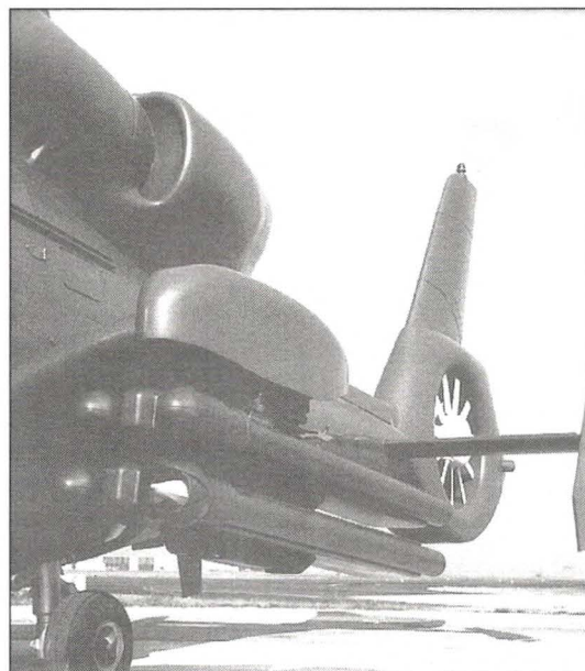
Misiles aire-aire "Mistral" que se montan en los helicópteros "Dauphin" y Panther".
