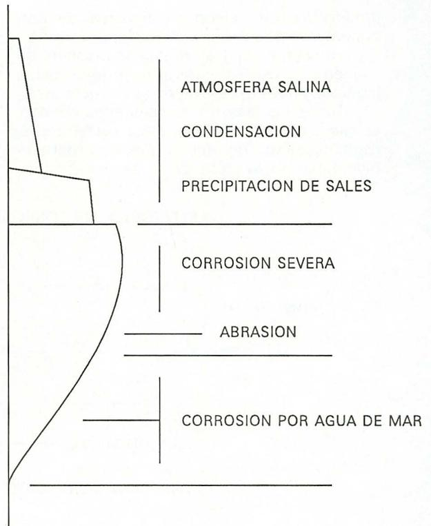
FIGURA 2. RANGO DE PROCESOS DE CORROSION QUE AFECTAN A UN BUQUE
