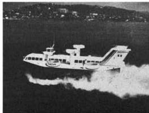
tura de 8 m. Puede llevar 120 pasajeros y dos toneladas de carga (en comparación con los 90 pasajeros del modelo anterior) y puede lograr una velocidad máxima de 105 km/h. con sus dos motores Turbomeca, Turmo III N6. La autonomía máxima es de 5 horas. De este modelo que se derivó una versión militar, el M300M, equipado con 3 montajes de 30 mm, dos de los
