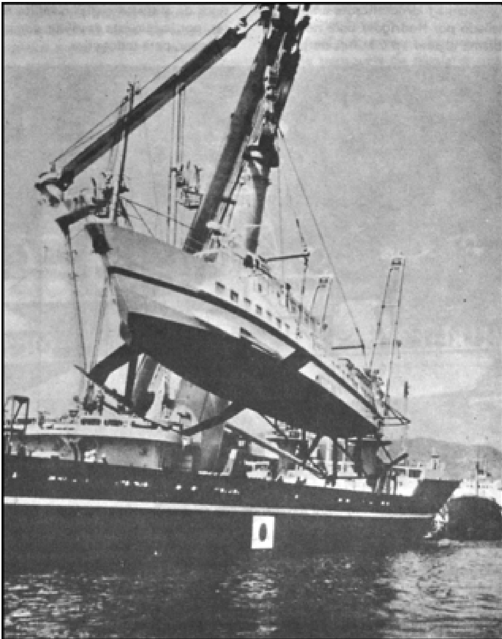
Embarque del aliscafo "Flying Dragón" en que pueden notarse los dos tándems de hidroalas.
