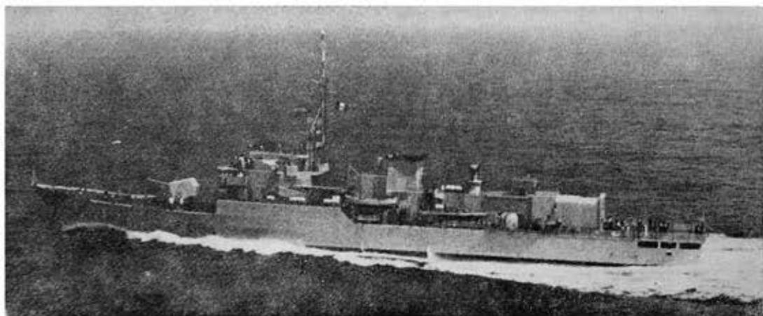
Vista lateral de la fragata "Lupo", con detalle del armamento. El hangar retráctil se encuentra aquí completamente desplegado.
