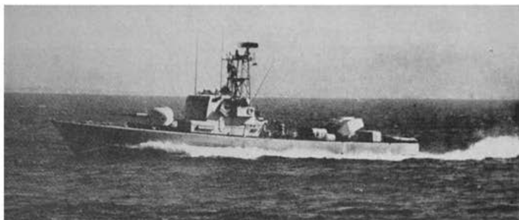
Otra configuración "Sa'ar" con un montaje triple "Gabriel" a popa y un cañón doble de 40 mm. en lugar de la instalación de 76 mm.
