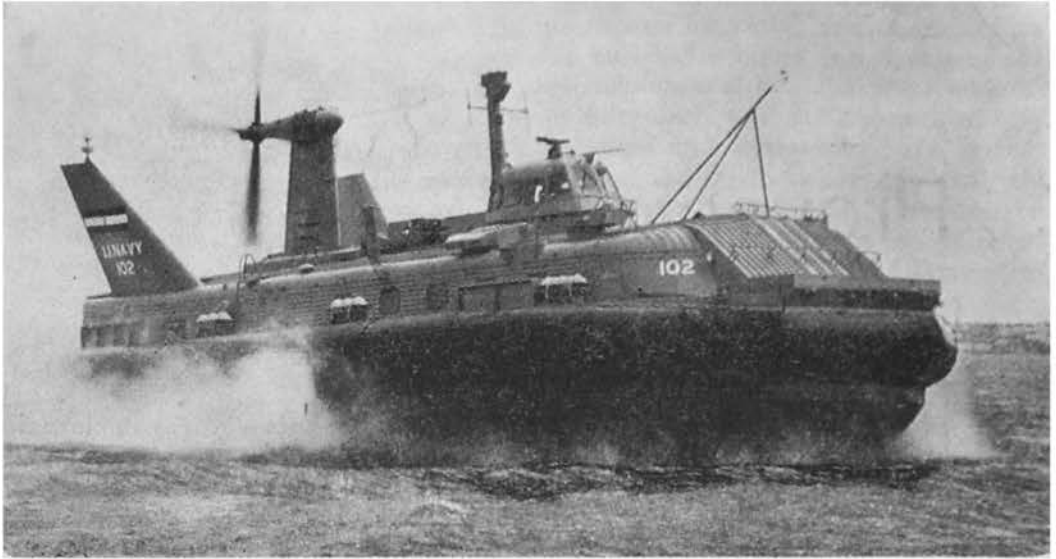
El BH 7 MK 4 para misiones de apoyo logístico que utiliza la Marina irania; es capaz de transportar 160 hombres pertrechados o 16 toneladas de carga con una autonomía de 700 millas (mar calma).
