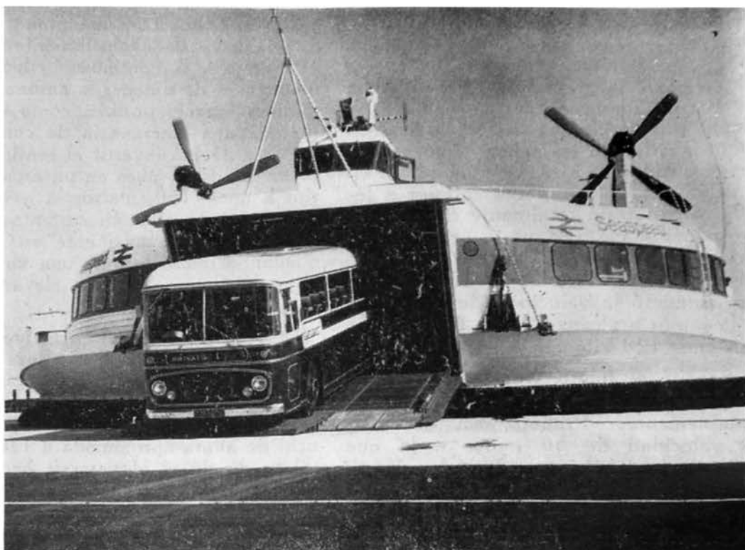
Un SR.N4 ya "posado" en el terminal, evacúa rápidamente los vehículos y carga por la amplia rampa de proa y los pasajeros por accesos practicados en las bandas. Una segunda rampa a popa permite una carga simultánea.
