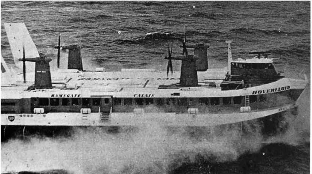
Un SR.N4 abordando el terminal de Calais aprovechando un largo desplazo de la costa. Los problemas de control y gobierno debido a la disminución de la velocidad para la aproximación, son resueltos con los timones de popa, hélices de paso variable y bases portahélices orientables.
