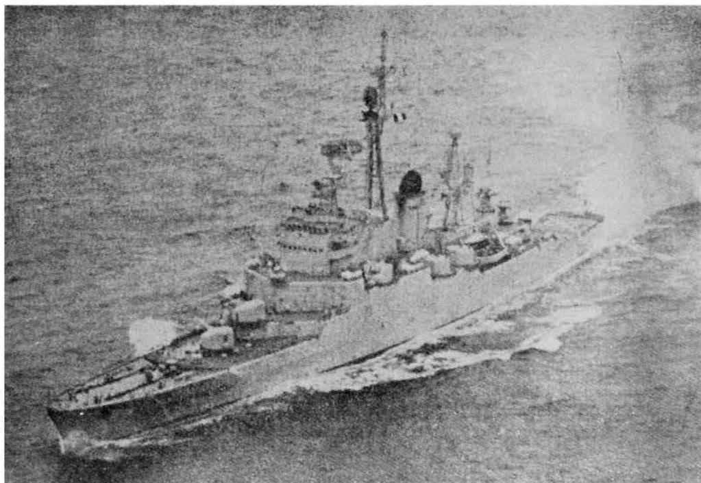
Ofrecemos a nuestros lectores una fotografía del crucero francés "Colbert" durante las pruebas que siguieron a su modernización. El "Colbert" está armado con dos montajes sencillos de 100 mm. a proa; tres montajes dobles de 57 mm. por banda y un lanzador doble para cohetes
