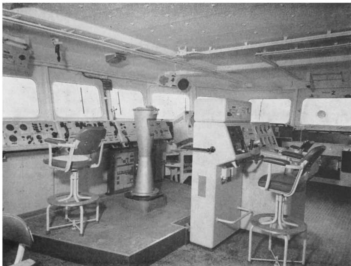
Puesto de control en el puente de una fragata CODOG de dos hélices.
