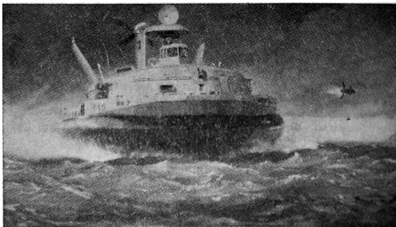
Hovercraft Tipo BH7 de 40 tons, propulsado por una turbina a gas Proteus.
