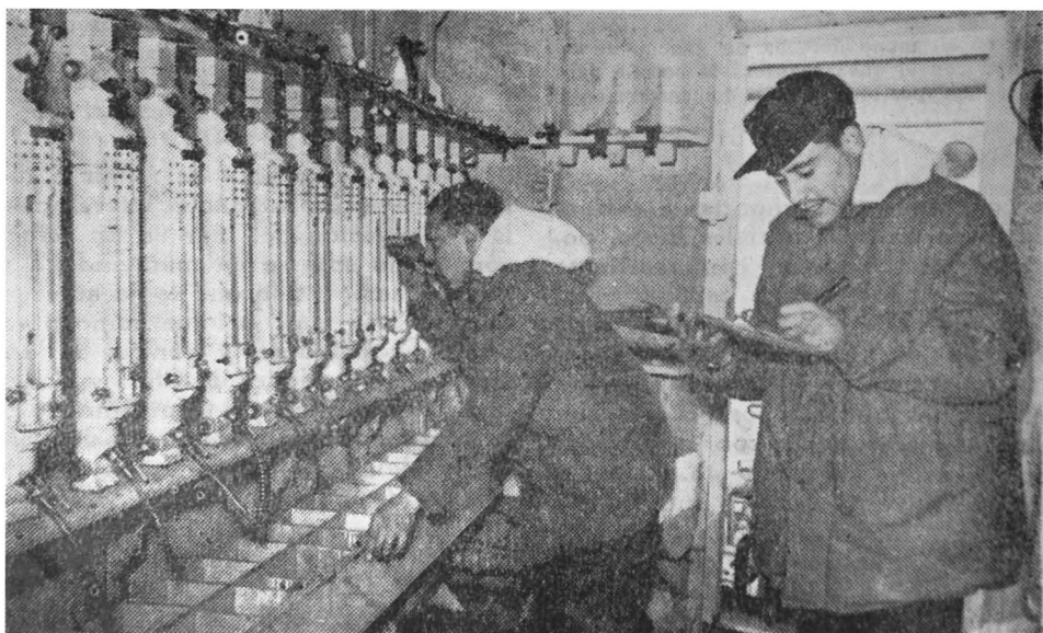
Lectura de las temperaturas del mar a diversos niveles de profundidad registrados por los termómetros de inversión montados en las botellas Nansen.
