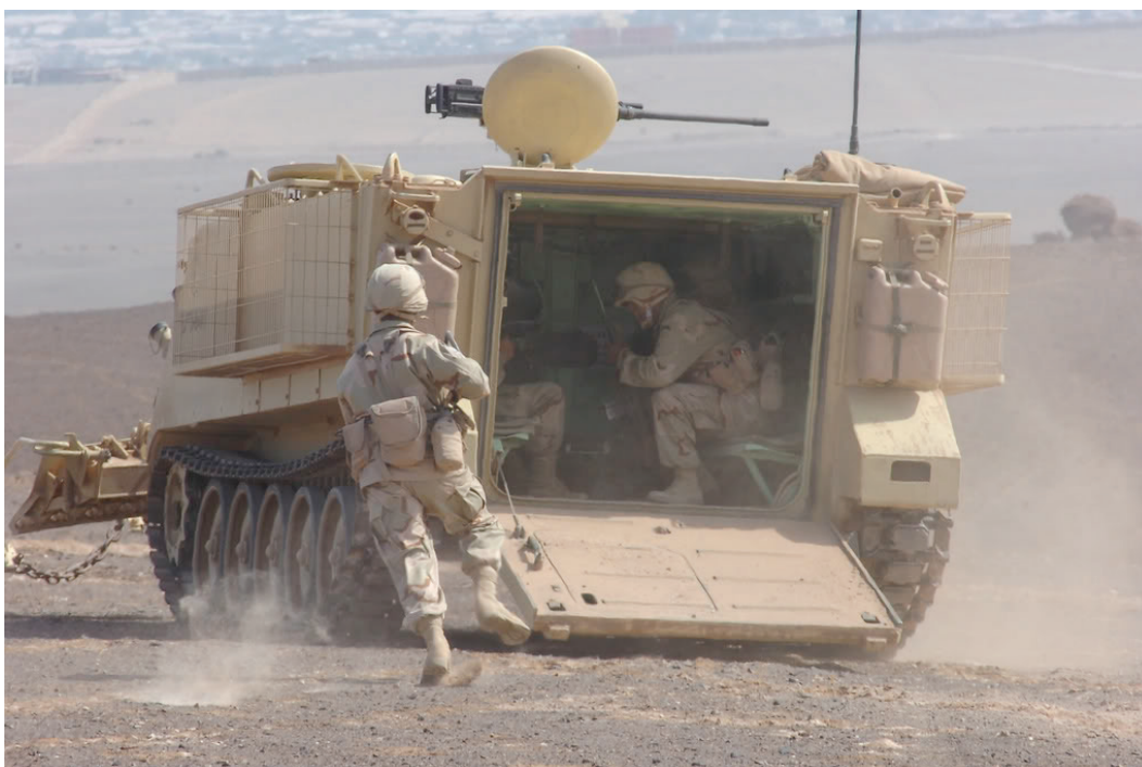
■ El carro M113 es un vehículo blindado de tracción por cadenas destinado al transporte de personal, material y varias armas.
